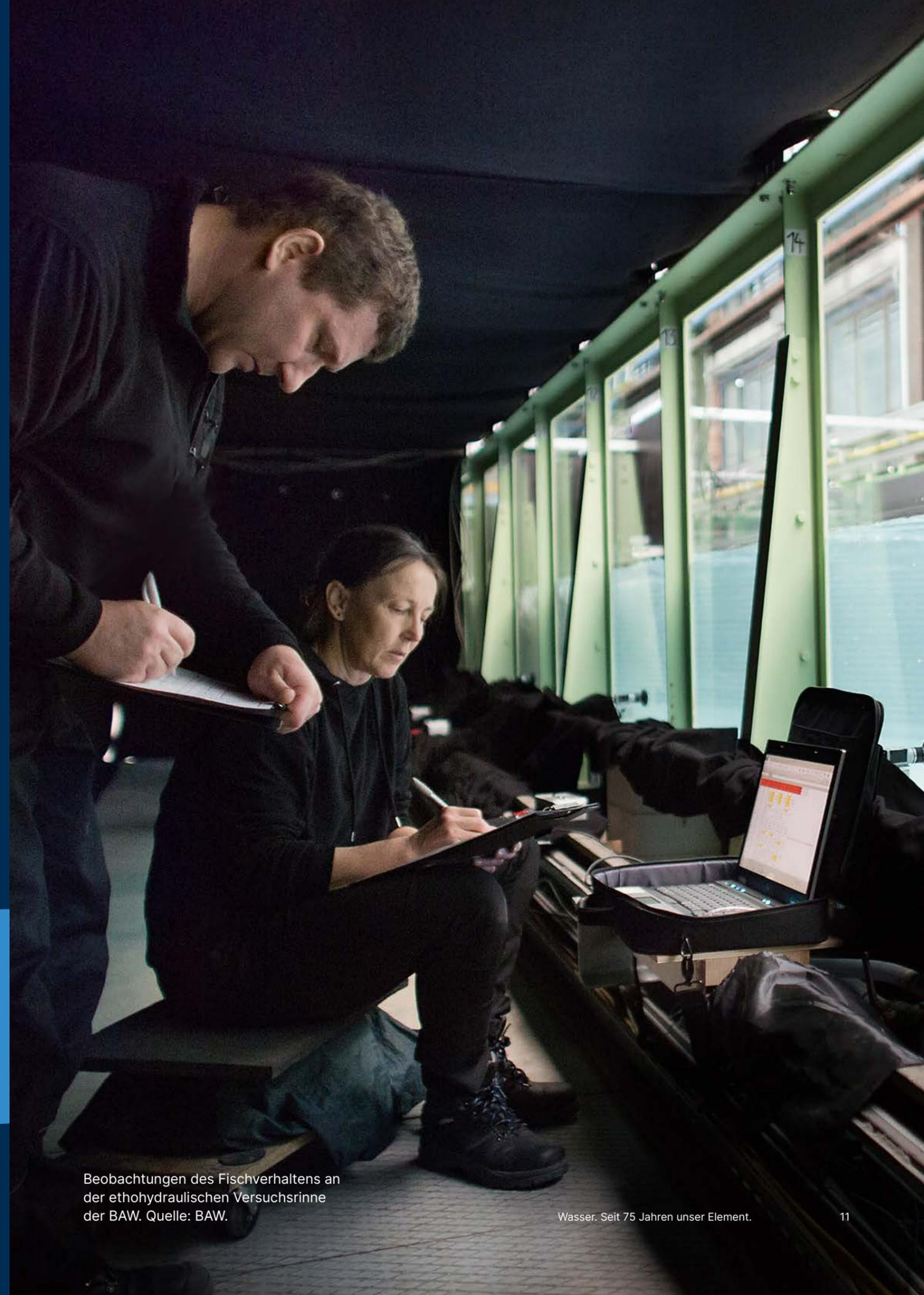
Beobachtungen des Fischverhaltens an der ethohydraulischen Versuchsrinne der BAW. Quelle: BAW.
