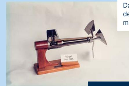
Flügel zur Messung der Fließgeschwindigkeit von 1925. Quelle: BfG-Archiv.
